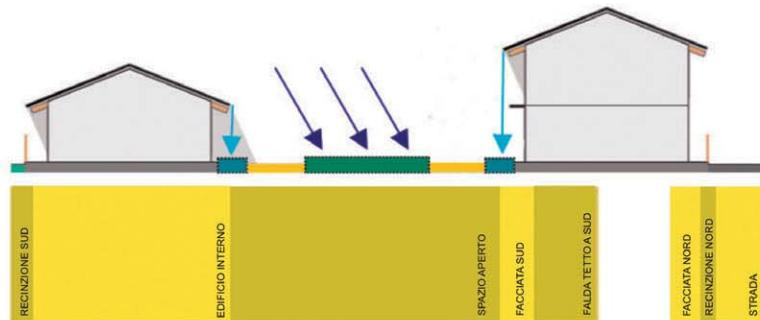
Articolazione della sezione di progetto degli spazi aperti tra gli edifici anche in funzione della gestione sostenibile dei deflussi meteorici: delimitazione di spazi di fruizione attraverso l'uso di **tecniche verdi per l'infiltrazione** delle acque piovane.
