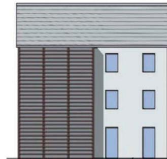
Nel disegno dell'involucro ci sarà una **equilibrata proporzione tra parti opache e parti vetrate** in modo da calibrare ridotta trasmittanza e corretta illuminazione.
