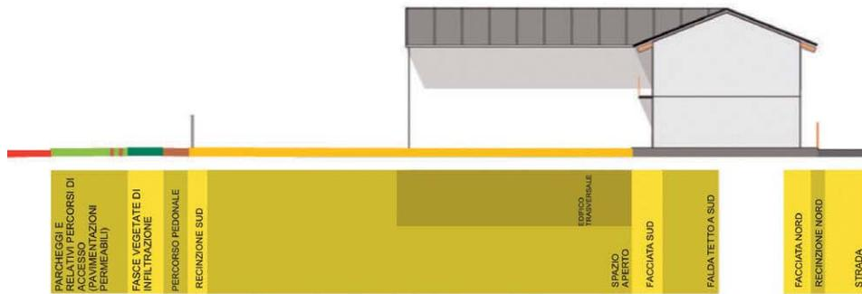
Articolazione della sezione di progetto degli spazi filtro tra strade e lotto anche in funzione della gestione sostenibile dei dilavamenti meteorici: le esigenze di **carrabilità** di parte delle superfici, di **accessibilità pedonale** ai percorsi e di delimitazione delle aree di stallo rispetto alla circolazione non motorizzata devono essere interpretate articolando il disegno del suolo anche attraverso l'utilizzo delle **tecniche di permeabilità**.
