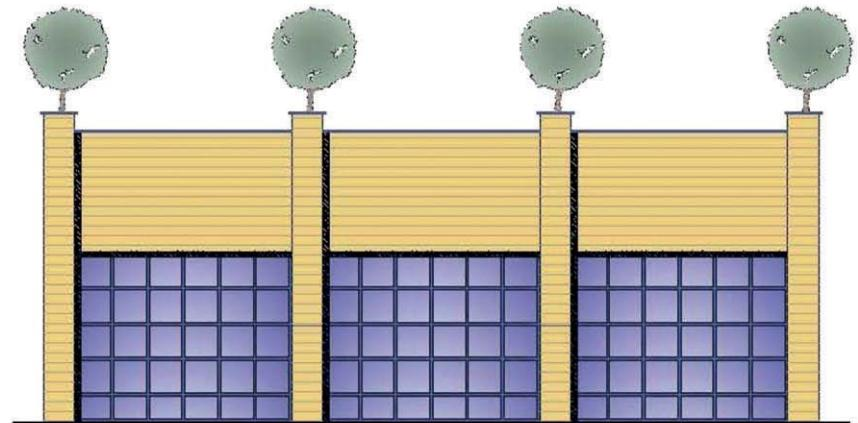
**Rivestimento in lamiera ondulata disposta in orizzontale (a).**
