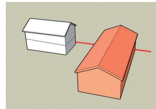
Composizione che tende a ricostituire l'aggregazione tipica dell'**edificio a L**: corpi ortogonali allineati rispetto alla facciata posteriore; il volume produttivo si accosta alla facciata di testata dell'edificio residenziale, lasciando libera quella principale.
