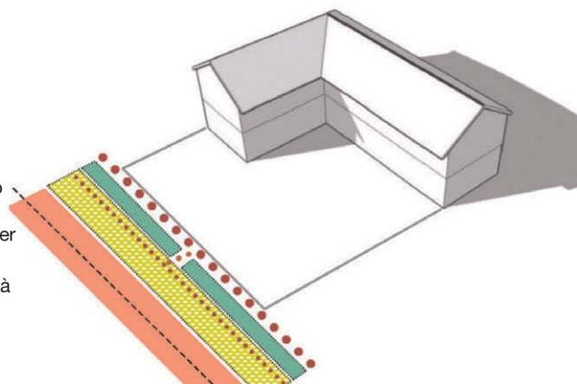
**Gestione dei deflussi meteorici nelle aree pertinenziali a parcheggio**, utilizzando specifiche soluzioni di pavimentazione al fine di limitare la mineralizzazione dei suoli in corrispondenza delle superfici carrabili.
