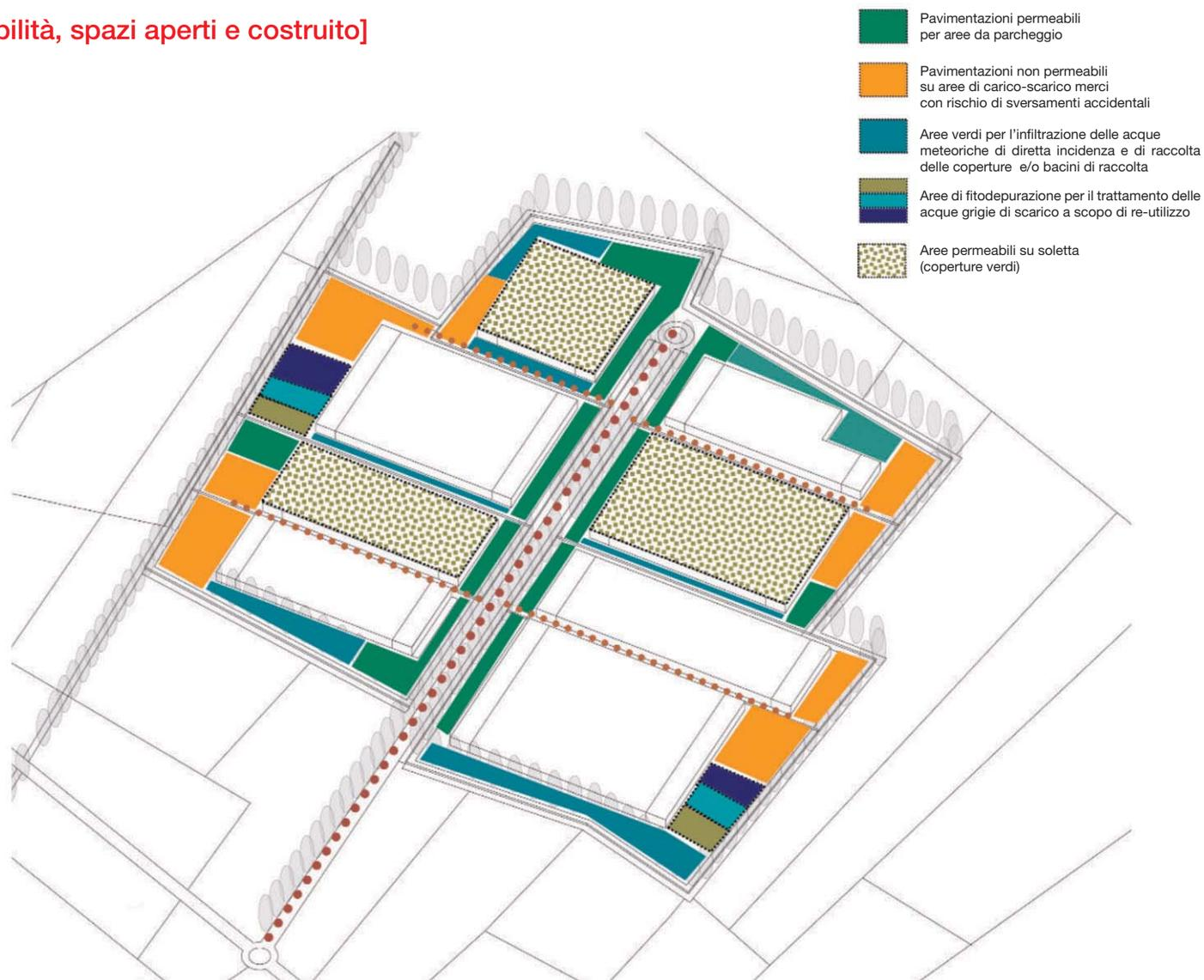
**Trattamento dei suoli con tipologie di pavimentazioni differenti, permeabili e non**, in relazione alla infiltrazione e recupero delle acque meteoriche e del trattamento delle acque grigie di scarico.
