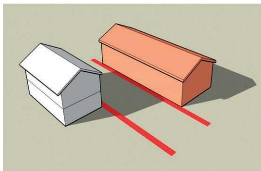
Composizione che tende a ricostituire l'aggregazione tipica dell'**edificio a corpi contrapposti**: il volume produttivo si dispone parallelamente a quello residenziale, allineato rispetto alla facciata posteriore.
