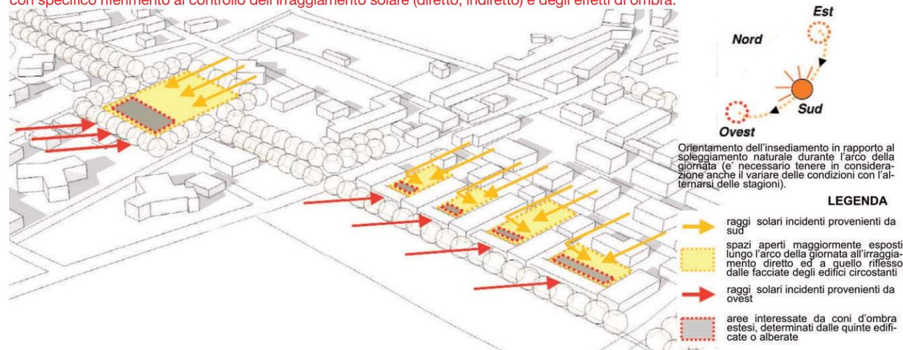
**Schema B:** gerarchizzazione degli spazi aperti anche in funzione della creazione di aree con differenti livelli di comfort termico - in relazione all'utilizzo previsto - attraverso la scelta dei materiali di pavimentazione.
