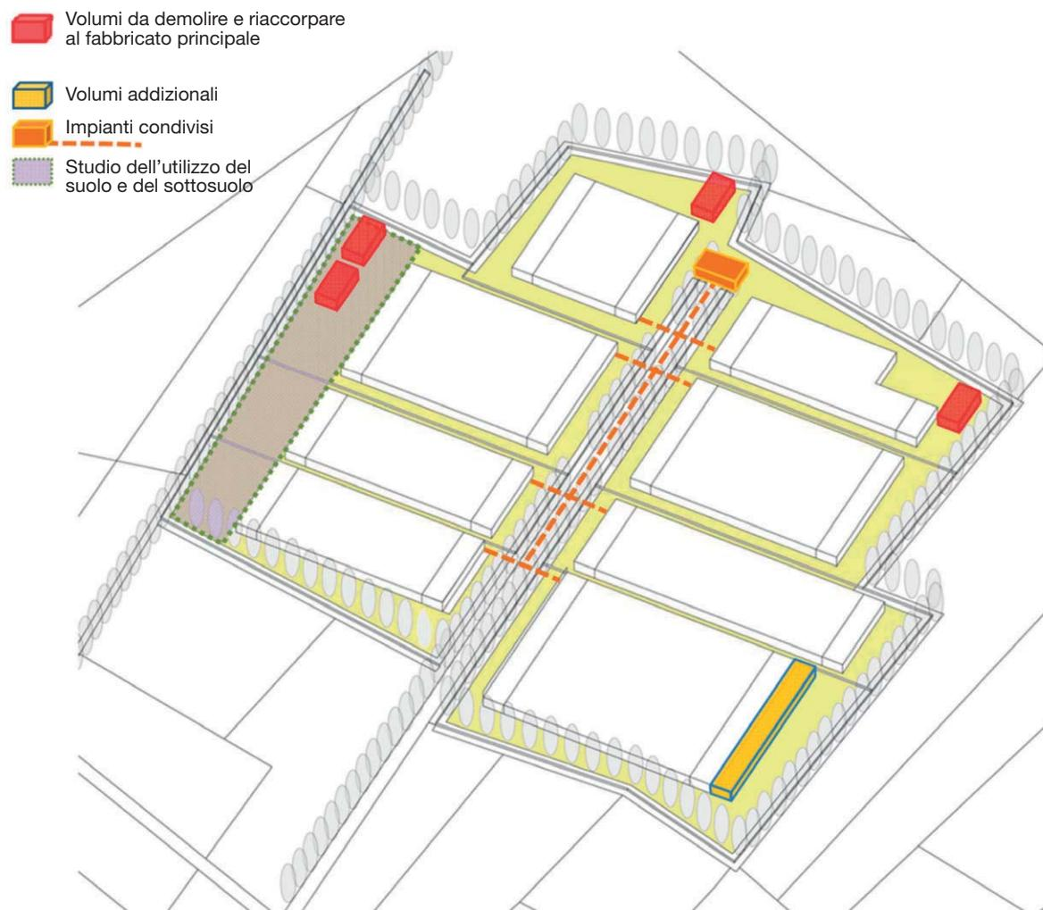
In un intervento di ridisegno del complesso produttivo verrà valutata l'opportunità di **razionalizzare l'uso del suolo** (rete di connessione idonea, compattazione dei volumi, trattamento permeabile delle superfici) e **ottimizzare l'uso e la produzione delle energie** (aumento di efficienza energetica, impianti per la produzione di energia).
