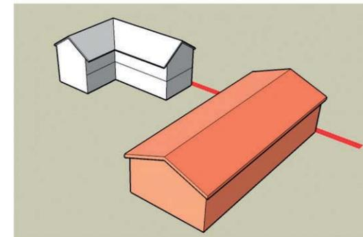
Composizione che tende a ricostituire l'aggregazione tipica dell'**edificio a C**: corpi ortogonali allineati rispetto alla facciata posteriore; il volume produttivo si accosta alla facciata di testata dell'edificio residenziale, lasciando libera quella principale.
