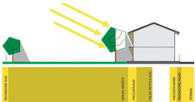
I sistemi di **schermatura potranno essere gli elementi stessi dell'edificio** (sporti del tetto, scuri delle finestre) di cui verranno studiati posizionamento e profondità.
