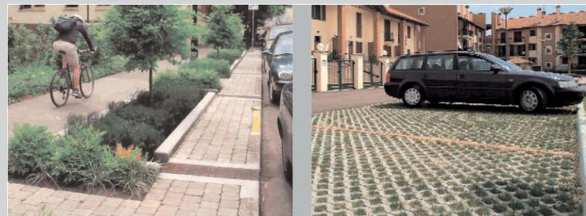
Il disegno degli spazi-filtro tra le infrastrutture veicolari e gli spazi pertinenziali del lotto deve essere articolato anche in relazione all'utilizzo delle specifiche tipologie di tecniche verdi per la permeabilità dei suoli (fasce vegetate di infiltrazione, trincee con ciottolati, pavimentazioni permeabili, asfalti porosi, ecc.).
